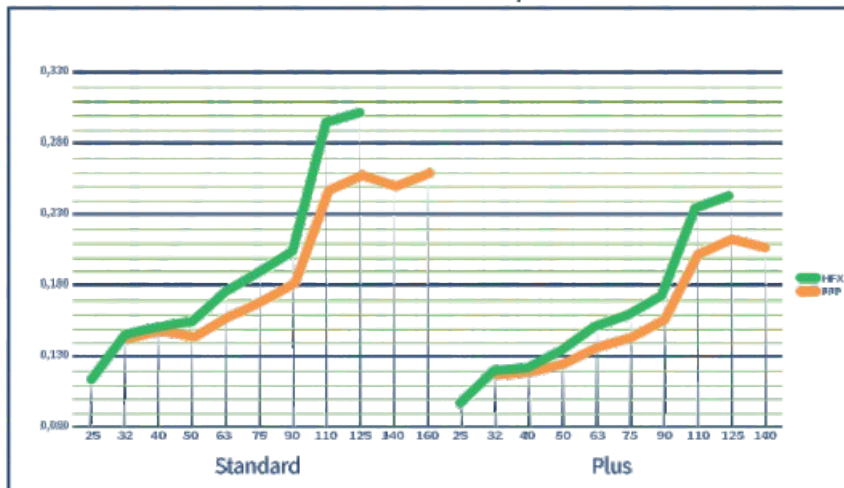
Poređenje U vrednosti [W/smK] Heatflex vs. FibreFlex Pro proizvoda
